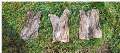
Materia que atascaba el sistema de depuración en Cuntis © Concello de Cuntis
